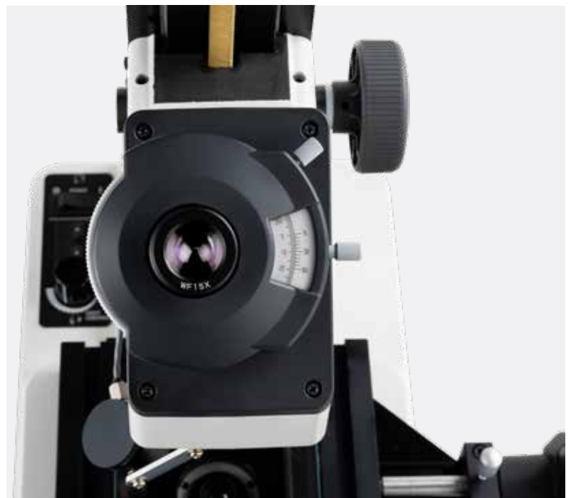
Az okuláron kívülre szerelt nóniusz skála lehetővé teszi az egyszerű szögmerést.
